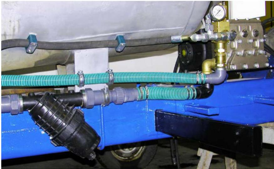
Wasserfilter in Pumpenzulauf-Leitung
