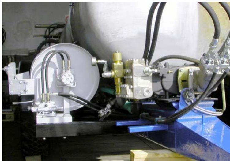
Hydr. Schlauchhaspel und hydraulisch angetriebene HD-Pumpe KF32
