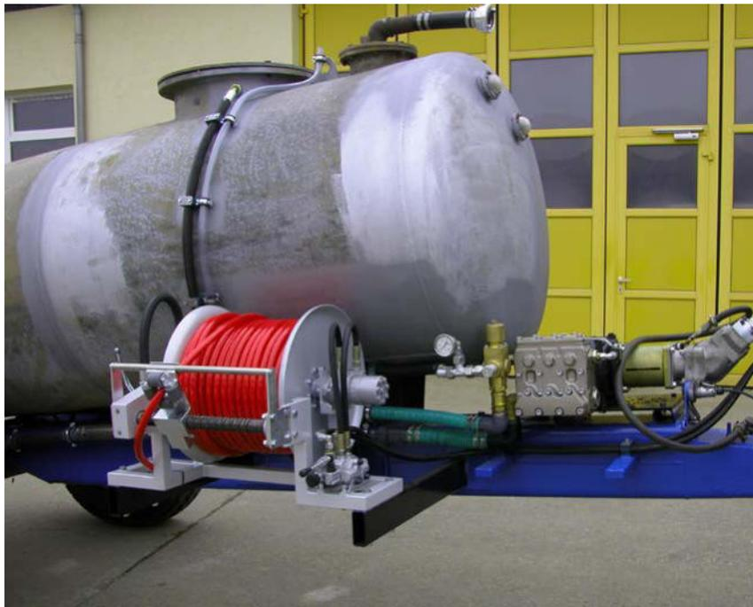
Schlauchhaspel mit 80m PVC-Kanalspülschlauch 1/2" – Wassertank 3m<sup>3</sup>
