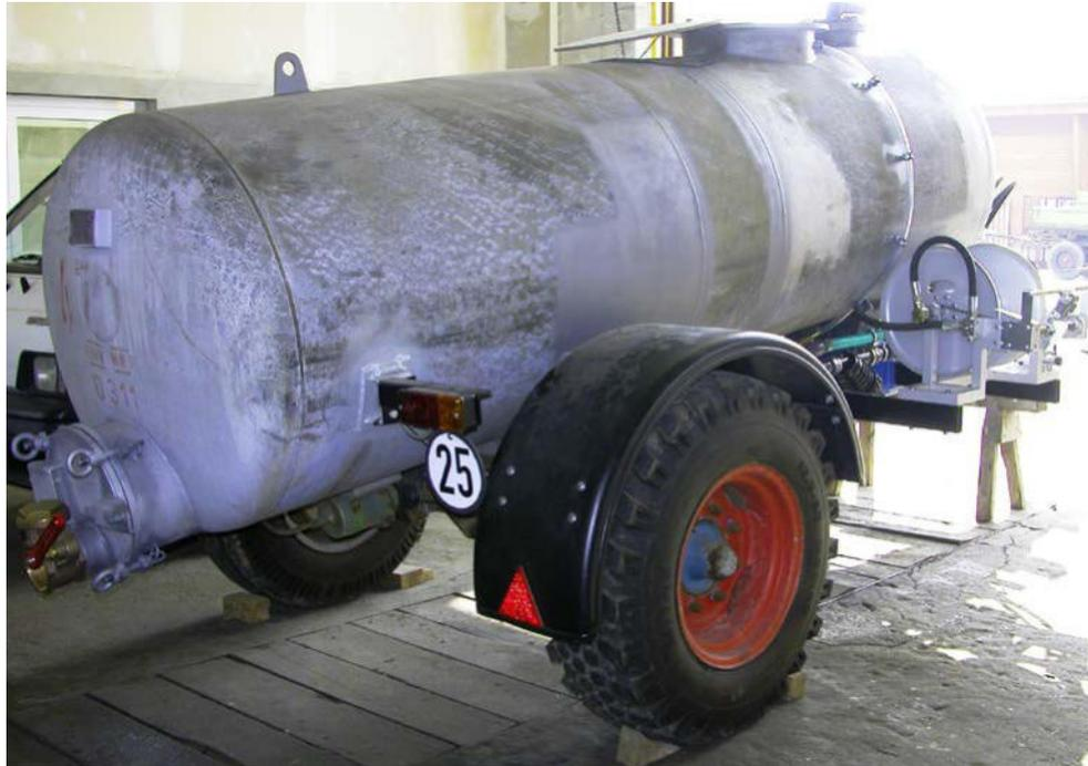
Umbau eines alten HTS 30 als Drainagespülgerät
