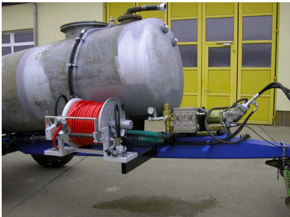
HD Pumpe KF32 über Hydraulikmotor von Zugmaschine angetrieben
